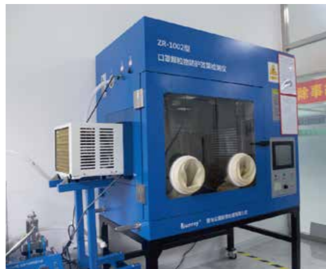
口罩颗粒物防护效果检测仪ZR-1002
